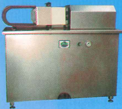
RENSA FORMADORA DE JAMONES POSTSALADOS IPO SERRANO (SISTEMA EMBOLAR Y LIMONAR) FE-3000
