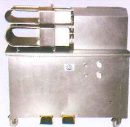
**PDF-3000** Prensa formadora con doble cabezal de jamones y paletas tipo serrano e ibérico (sistema embolar y limonar).
