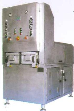
**PFD-4000** Prensa formadora de doble cabezal tipo rectangular para lonchear con mërma 0. Para jamón curado, jamón de pato, lomo, cecina, etc...
