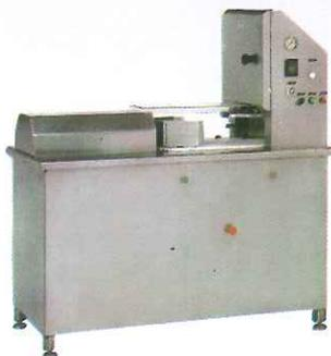
**PF-2500** Prensa formadora de jamones curados deshuesados tipo serrano e ibérico. Con cambio de molde.
