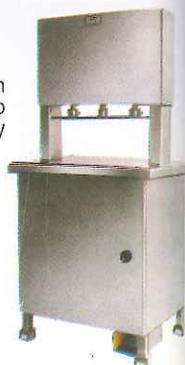
**PMN-250** Prensa para jamones postalados tipo serrano (sistema de prensado plano).
